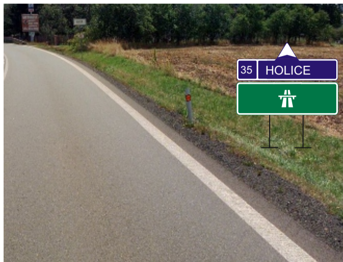
DZ na sil. od Hradce Králové před obcí Býšť - změna směru IS 1c na IS 1a
